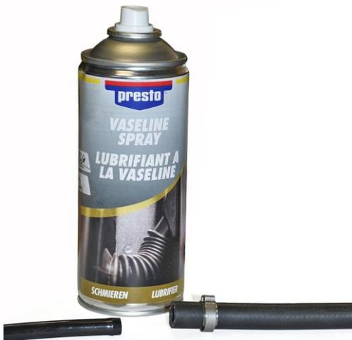
7. Einrohrklemme auf den Kraftstoffschlauch aufstecken und gemeinsam auf das Polyamidrohr soweit aufschieben das die Klemme ausreichend Platz zur Positionierung nach der Wulst hat.
