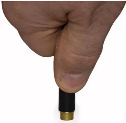
4. Vollständig eingepresste Einbündelhülse mit entstandener Wulst am Polyamidrohr
