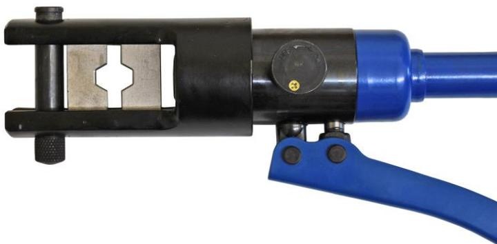
4. Polklemme mit bis zum Anschlag eingeschobener Litze in das Presswerkzeug einsetzen. Es ist darauf zu achten, dass vor dem Pressen die Polklemme so zu positionieren ist, dass der Kabel-Schaft ca. 2-3 mm vom Pressbacken entfernt ist.
