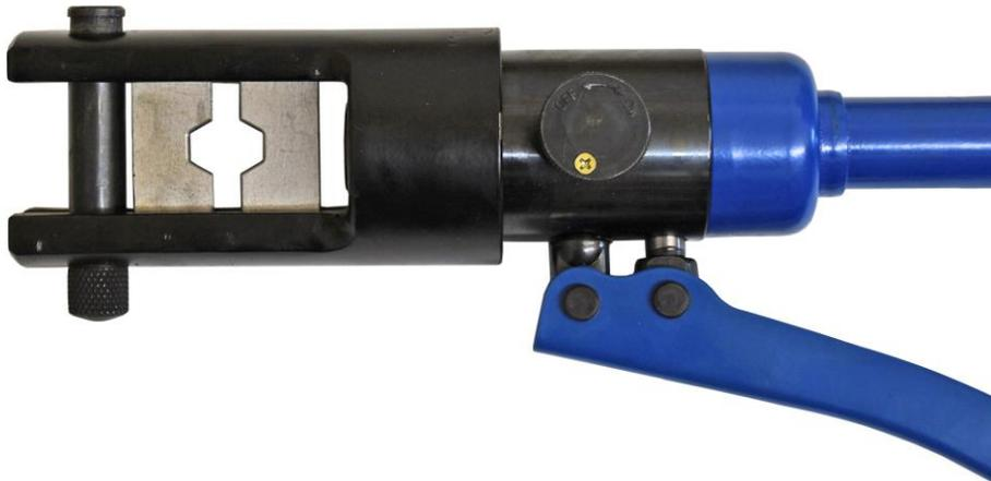
4. Polklemme mit bis zum Anschlag eingeschobener Litze in das Presswerkzeug einsetzen. Es ist darauf zu achten, das vor dem Pressen die Polklemme so zu positionieren ist, das der Kabel-Schaft ca. 2-3 mm vom Pressbacken entfernt ist.
