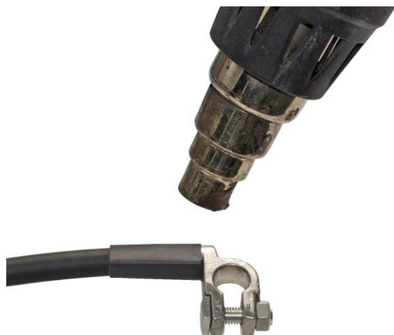
6. Unter Beobachtung weiter erwärmen, bis an den Schrumpfschlauchenden der Heißkleber leicht austritt. Dann sofort den das Erhitzen beenden, um Schäden am Schrumpfschlauch und an der Kabelisolation zu vermeiden.
