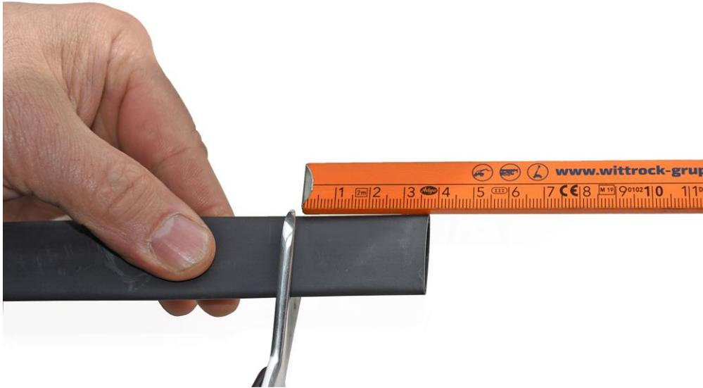
3. Schrumpfschlauch vor dem Pressen über das Kabelende schieben
