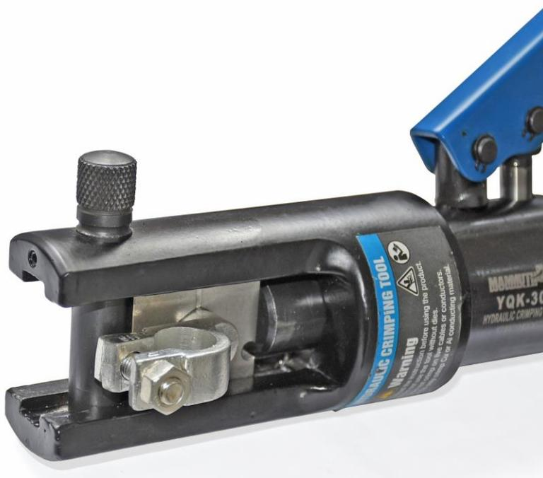
6. Fertig angepresste Batteriepolklemme
